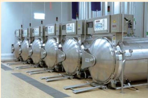
圖四 塑膠罐頭包裝食品及程式控制殺菌過程溫度與壓力的新式殺菌釜
