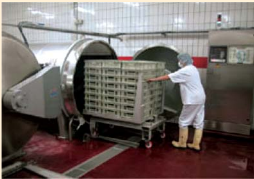
圖六 真空調理冷藏食品 (Sous-Vide 加工食品) 的熱處理與冷卻設備
