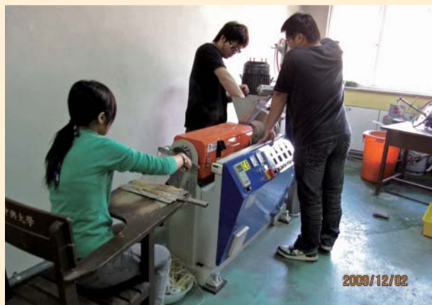
圖 9 物料在擠壓機內之滯留時間分佈實驗
