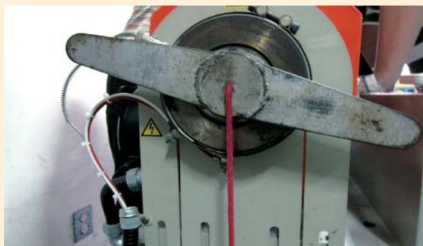
圖 10 以紅色染料測定物料在擠壓機內之滯留時間分佈
